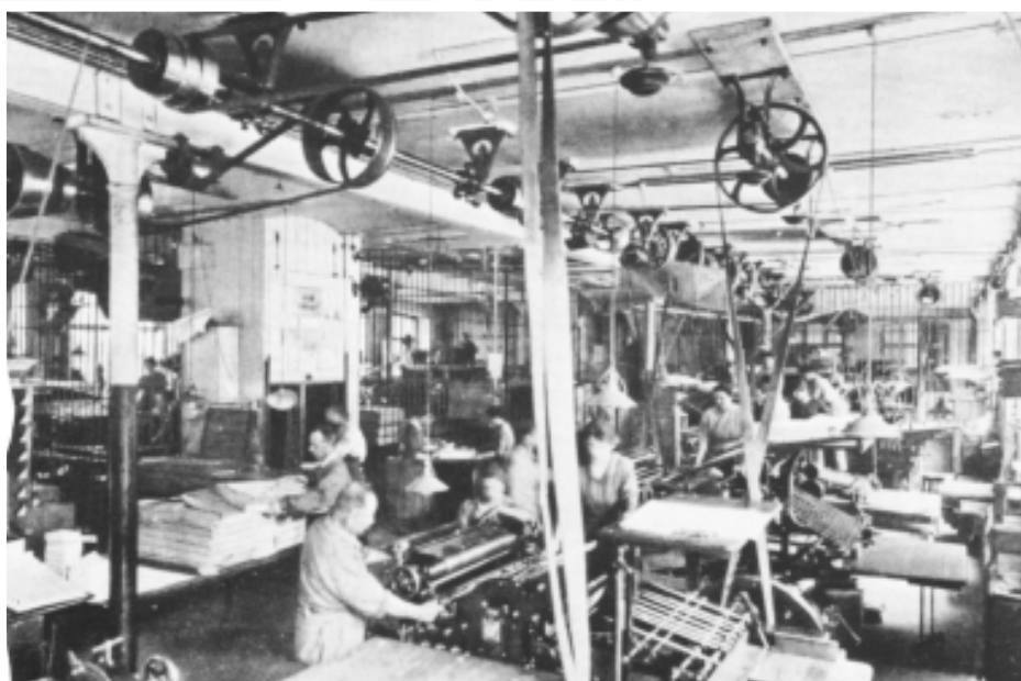
Arbre de commande central pour l'entraînement de toutes les machines de l'atelier. Transmission de la force motrice aux machines par courroies ...
