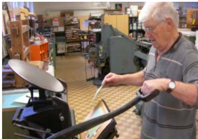
Commande manuelle pour la presse à platine Boston
